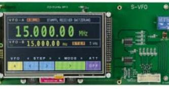
Universell für Eigenbauprojekte mit 21,4-MHz-ZF einsetzbar. Entwickler Heinz Stampfl, HB9KOC. Frequenzbereich 21,5...51,4 MHz. Abstimmsschrittweite umschaltbar 10, 100 Hz, 1, 5, 9, 100 kHz, 1 MHz. Stabilität (0...60 °C) 1 ppm. Betriebsspannung 9...16 V. Platinenabmessung 110 x 56 mm. Beschreibung siehe FA 6/2021
