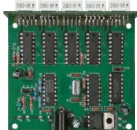
5-stelliges LED-Anzeigemodul, Auflösung 1 kHz, Betriebsspannung +5 V oder +7... 18 V, Stromaufnahme max. 65 mA, 13 mm hohen LED-Siebensegment-Anzeigen, Hauptplatine 80 mm x 70 mm.
