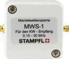
Frequenzbereich 0,15 bis 30 MHz. Hilfsmittel zur Empfangsverbesserung. Nicht zum Senden geeignet. Einfügedämpfung < 1 dB. Anschlüsse SMA. Schutzart IP6. Abmessungen (ohne Buchsen) 53 x 53 x 36 mm
