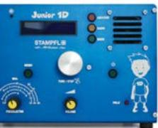
Kurzwellenempfang von 1,5 bis 30 MHz, AM und DSB. Abstimmung mit 10-Gang-Poti. Digitale Frequenzzanzeige und manueller Preselektor. Der Testbericht dazu wurde im FA 10/2017 veröffentlicht. Bauanleitung downloadbar auf [www.box73.de](http://www.box73.de)
