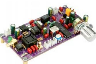
Bausatz von HB9KOC für eine universelle Baugruppe für Selbstbau-Empfängerprojekte bis 100 MHz. Schaltungsprinzip Doppelsuperhet (21,4 MHz/455 kHz). Eingangsimpedanz 50 Ω. Empfindlichkeit -117 dBm (AM, m=80%, B=6 kHz). Betriebsspannung 12 V. Abmessungen 110 x 56 mm. Beschreibung siehe FA 6/2021
