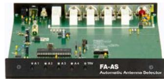
Der FA-AS ermöglicht es, vier Antennen anzuschließen und je nach Betriebsfrequenz über die analoge Bandspannung oder CI-V automatisch zu wählen. Er eignet sich außer für den IC-7300 auch für alle modernen Icom-TRX.
