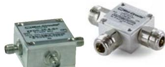
Für Messzwecke usw. innerhalb eines Frequenzbereichs von 100 kHz bis 2 GHz nutzbar. 20 dB Auskopplung, Einfügedämpfung typ. 0,7 dB. Ausführungen mit SMA- oder N-Buchsen im Sortiment. RoHS-konform
