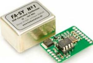
FA-SY 1-Bausatz für einen USB-steuerbaren Universal-Oszillator für Frequenzen von 10 bis 160 MHz. Herzstück ist ein SiLab-IC Si570 in CMOS-Version ( $\pm 31,5$  ppm, mit der On-board-Heizung reduzierbar). Größe 36 x 27 x 19 mm, alle SMD-Teile bestückt. Stromversorgung über USB oder/und 12 V extern.
