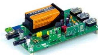
Bausatz für einen ISM-Transceiver für die drahtlose CW-Kommunikation über kurze Entfernen.
