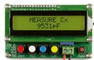
Einbaufertiges, geprüftes LC-Meter-Modul mit beleuchtetem Display. Messbereiche: 1 pF-10  $\mu$ F, 1 nH-100 H, Stromversorgung +5 V/20 mA über USB- oder DC-Buchse
